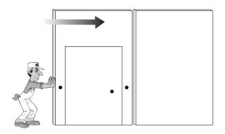
**Paso 1:** Accionar el mecanismo que está en la cara anterior del panel más cercano, colocando la llave operativa en la abertura del panel y dándole media vuelta.
